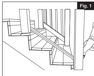
Colocar el travesaño inferior, con los orificios para los barrotes hacia arriba, sobre el tablón con la etiqueta que dice "This end top at top..." (este extremo hacia arriba) en el poste superior (Fig. 2).
