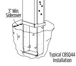
Dimensions (in.) Number of Post Model No. SD Screws Size W1 W2 Н D (preferred) CBSQ44-SDS2HDG 4x4 3%6 3½ 7% 8% 14-SDS 1/4"x2" 4x6 3% 51/16 713/16 811/16 14-SDS 1/4"x2" CBSO46-SDS2HDG CBSO66-SDS2HDG 6x6 5½ 5½ 14-SDS 1/4"x2" 6% 83/4 CBS086-SDS2HDG 6x8 7½ 5% 6% 811/16 12-SDS 1/4"x2" CBSQ88-SDS2HDG 8x8 7½ 7% 811/16 12-SDS 1/4"x2" 6%
